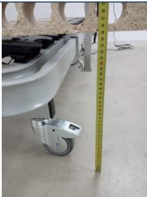
Fotografías: Ensayo de rango de altura de plataforma.
