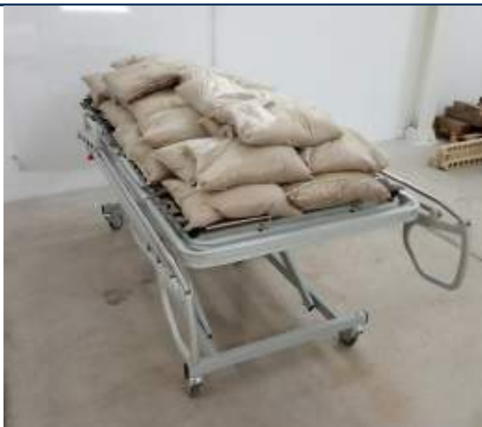
Fotografías: Ensayo de fuerzas estáticas debidas a cargas de paceintes.
