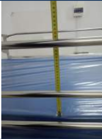
Fotografías: Ensayo de protección frente a caídas involuntarias de pacientes.
