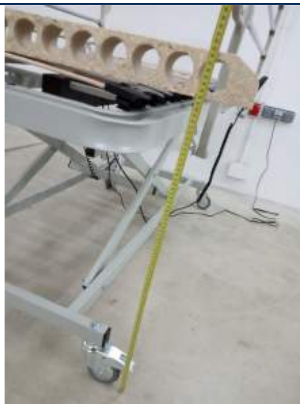
Fotografías: Ensayo de rango de altura de plataforma.
