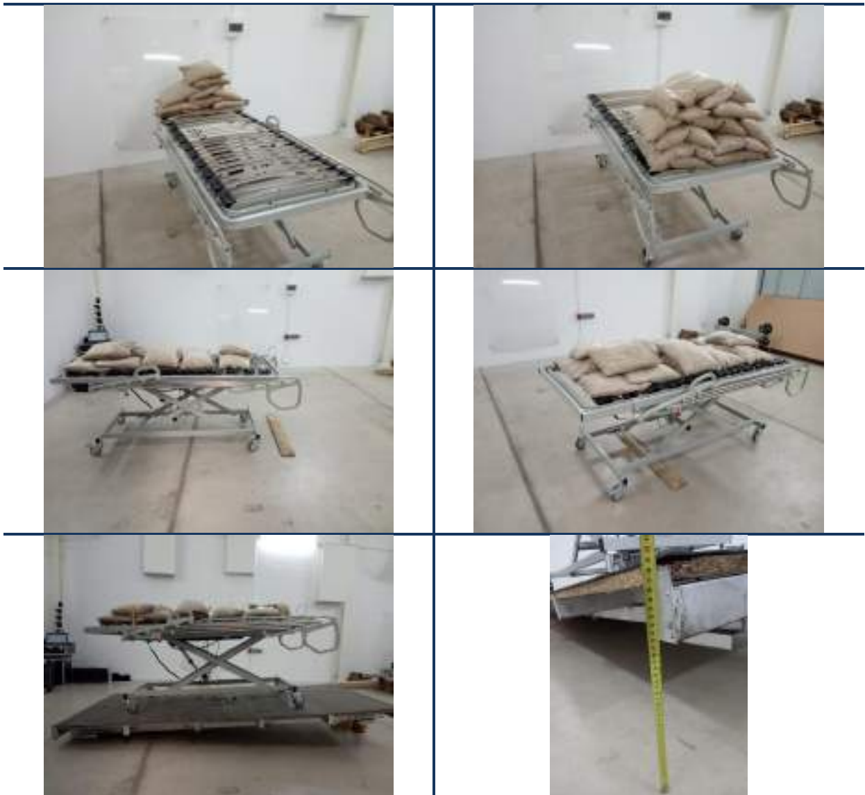
Fotografías: Ensayo de estabilidad
