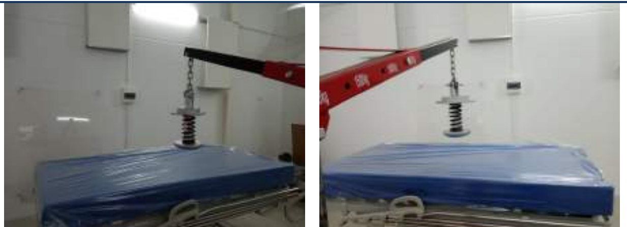
Fotografías: Ensayo de impacto sobre la plataforma del colchón.
