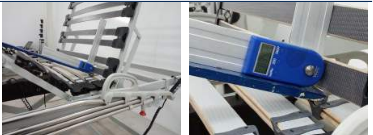
Fotografías: Ensayo de limitación de movimientos.
